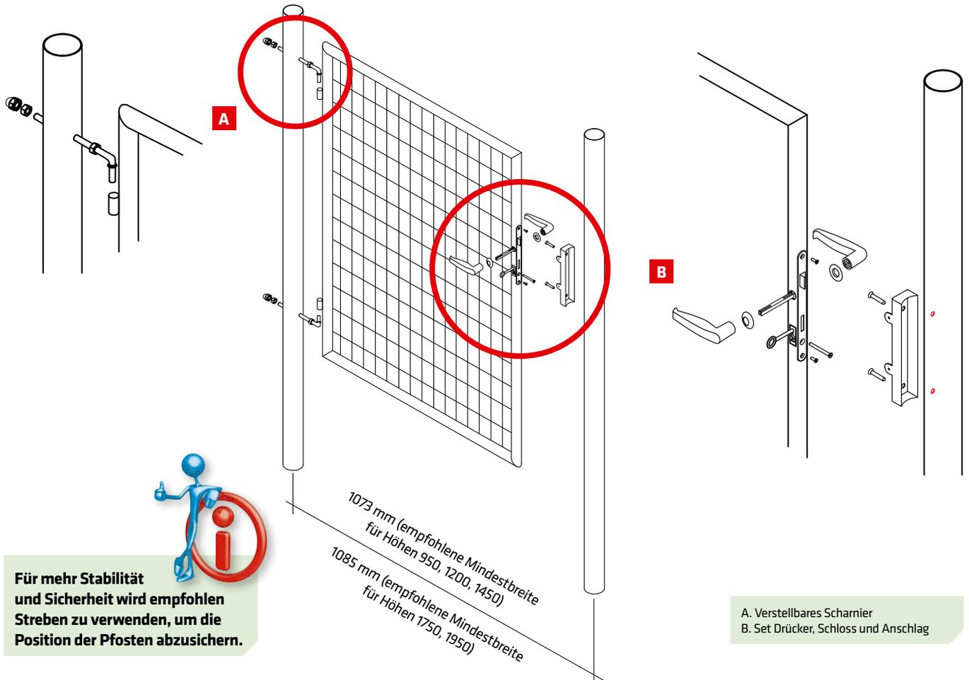
Für mehr Stabilität und Sicherheit wird empfohlen Streben zu verwenden, um die Position der Pfosten abzusichern.
